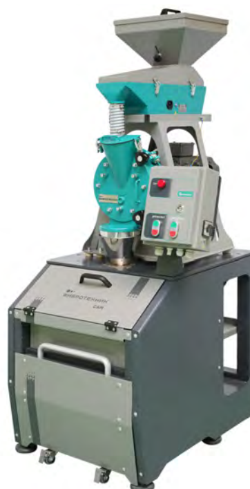
Технологическая установка на базе ИД 175М с Питателем ПГ 1 и Сократителем САМ
