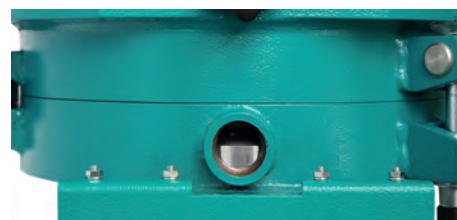
Отверстие для контроля зазора между дисками
