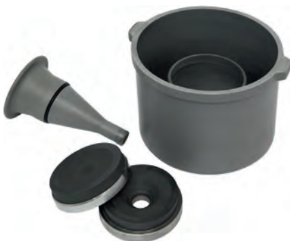
Загрузочная воронка, приемная емкость и диски ИД 65
